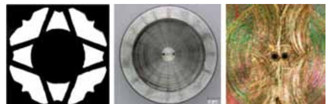
Lochanordnungen zur Erzeugung von Doppelstrahl Flüssigkeitssprays
