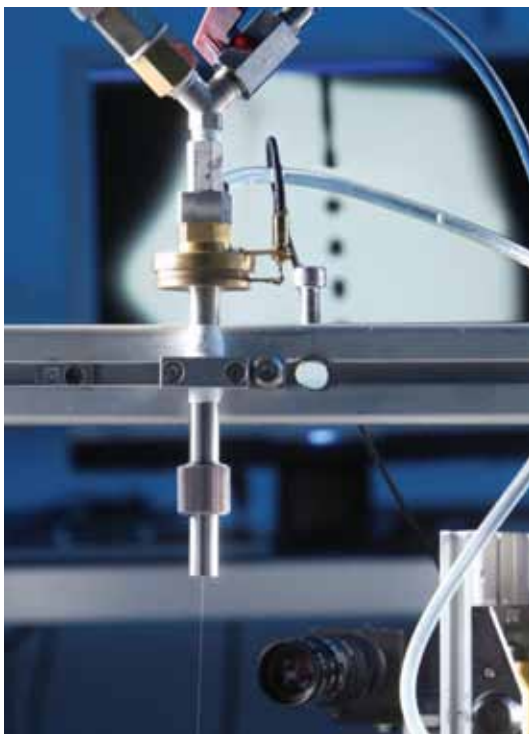
Versuchsstand zur Überwachung der Tropfenbildung
