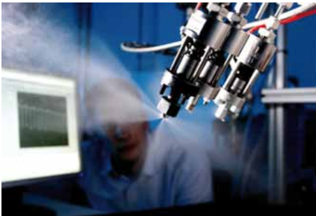
FMP-Versuchsstand zur Untersuchung von Sprays
